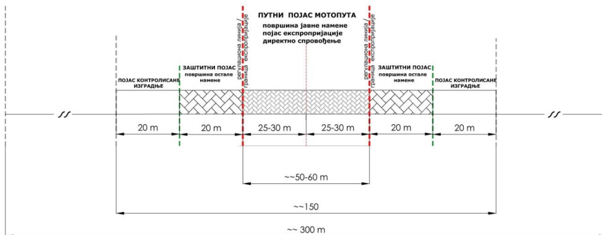
Слика 2. Шематски приказ попречног профила коридора мотопута
